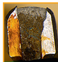
Detalle: Pinzas de boca partida con estructura fracturada intercristalina granulada típica.
