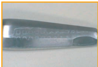
Arrastre de residuos de detergente debido a un aclarado insuficiente
