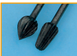
Óxido en las fresas. Causa: Tratamiento de un instrumento de un sólo uso
