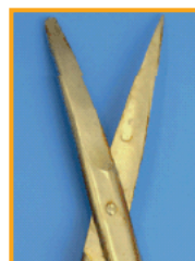
Tijeras corroídas en acero inoxidable. Causa: daños secundarios debido a un ataque ácido, producido por una sobredosificación del limpiador básico.
