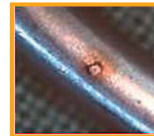
Corrosión de picadura en unas pinzas. Causa: El envejecimiento acelerado de la cinta de código cromático permite la infiltración de sustancias perjudiciales con cloruro.
