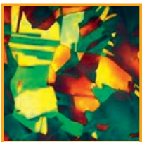
Grabado de color - micro estructura austenítica de acero anticorrosivo y resistente al ácido para instrumentos (resolución x500)
