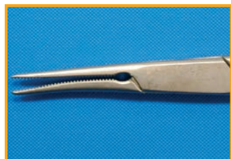
Deformación debida a manejo inadecuado
