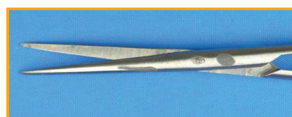
Izquierda: ataque parcial al material debido al uso de eliminador de cemento ácido, y en la derecha debido a tintura para el restañó de la sangre. Causa: tiempo de contacto demasiado elevado o limpieza insuficiente tras la utilización.
