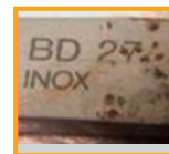
Corrosión de picadura en unas pinzas. Causa: El envejecimiento acelerado de la cinta de código cromático permite la infiltración de sustancias perjudiciales con cloruro.
