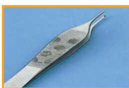
Manchas sobre una pinza. Causa: calidad del vapor insuficiente
