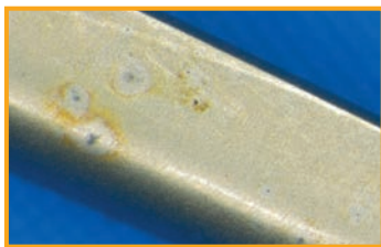
Picaduras de corrosión inducidas por cloruro en un instrumento
